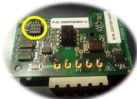
Bild 8: Anordnung der DIP-Schalter auf der Thermistor-Ein-/Analog-Ausgangs-Optionskarte
